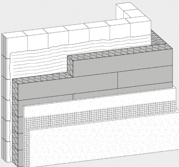
Nichtbrennbare Steinwolle-Lamelle als Kernstück für Wärmedämm-Verbundsysteme. Durch senkrecht zur Bauteiloberfläche ausgerichtete Wollstruktur hohe Druck- und Abreißfestigkeit, die eine dübelfreie Verlegung bis zu einer Windsogkraft  $< 1,6 \text{ kN/m}^2$  ermöglichen. Speedrock II ist werkseitig beidseitig mit einer mineralischen Beschichtung versehen und ermöglicht bei maschineller Verarbeitung des Klebemörtels eine 50 % schnellere Verlegung gegenüber herkömmlichen Lamellen.
